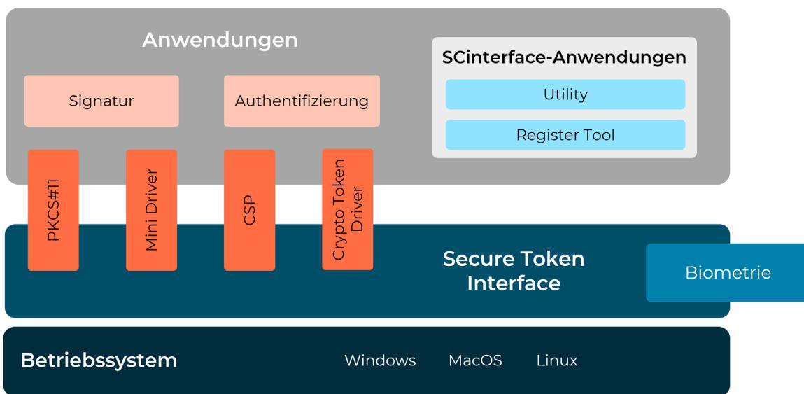
Cryptovision SCinterface eID ist eine modulare Lösung, die auf allen gängigen PC-Betriebssystemen läuft und zahlreiche kryptografische Schnittstellen unterstützt.
