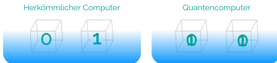
Abbildung 5: Ein Bit eines herkömmlichen Computers kann stets nur den Wert 0 oder 1 annehmen. Bei einem Quantencomputer-Bit (Qbit) sind dagegen beide Zustände gleichzeitig möglich. Mit Qbits lassen sich daher mehrere Berechnungen gleichzeitig durchführen.
